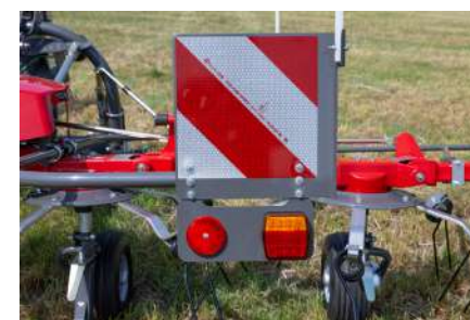
Nová koncepce moderního osvětlení LED včetně výstražného panelu zvyšuje bezpečnost a prodlužuje životnost.
