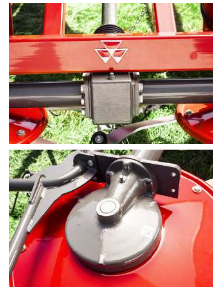
Nízké náklady na vlastnictví a snadná údržba díky bezúdržbovým dvojitým spojkám a snadnému přístupu k maznicím otočných čepů a olejem plněné převodovce.
